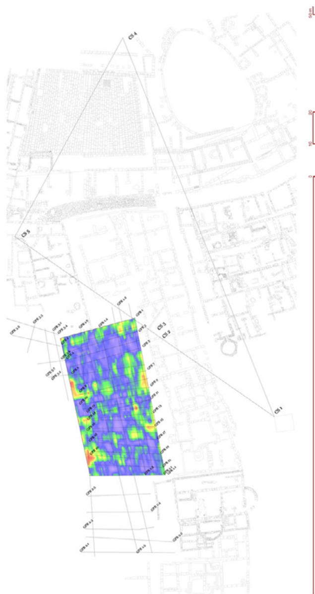
Fig. 1. Restituzione della tomografia 3d ottenuta con tecnica georadar (antenna 400-900 MHz) di un settore adiacente allo scavo Quagliati nel sito archeologico di Egnazia (BR) finalizzata alla comprensione del tessuto urbano ad all'interpretazione della forma insediativa. Collocazione dell'area indagata nella planimetria degli scavi (elaborazioni a cura del gruppo di lavoro "FIRB 2012": Disabato, Macina, Pinto, Polignano, Sica; coordinamento scientifico: Martines).
